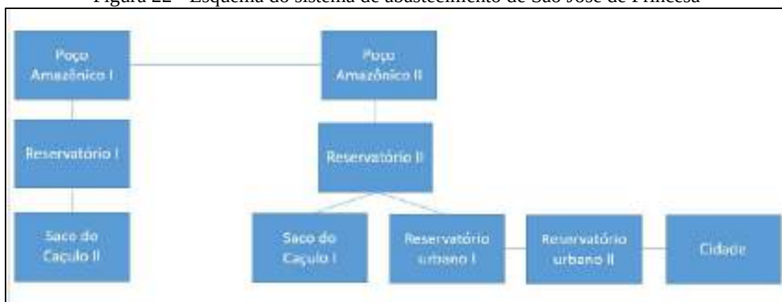
Figura 22 - Esquema do sistema de abastecimento de São José de Princesa
